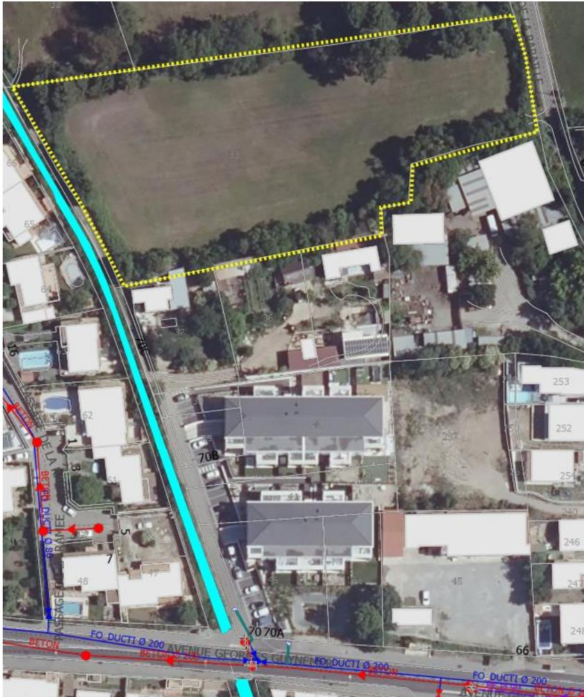
L'aménagement de cette zone nécessitera une extension des réseaux AEP (Fonte Dn 200) et EU (PVC 200) sur le chemin de Papaille. Ces extensions sont prévues dans le cadre d'un PUP.
