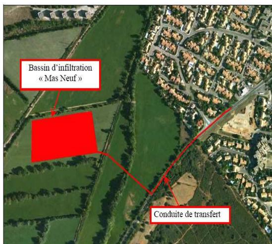
Il est proposé de créer un bassin de rétention / infiltration pour le quartier Mas Neuf / Monteau au Sud Ouest des zones urbanisées sur la commune d'Istres. Le bassin a pour surface 4 000 m<sup>2</sup> et un volume 4 700 m<sup>3</sup> (entrée du bassin de 1.6 m<sup>3</sup>/s et infiltration à 10<sup>-4</sup> m/s).
