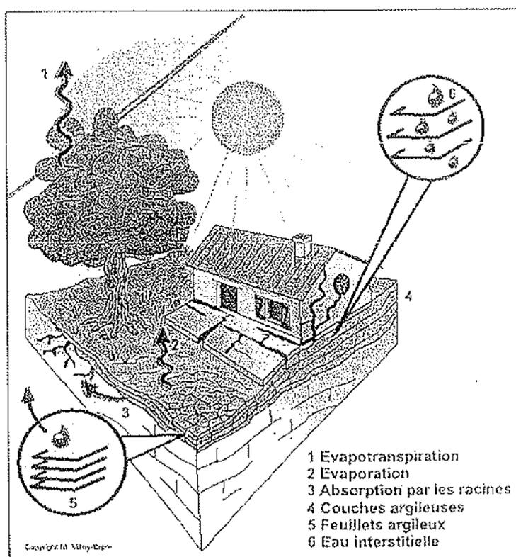
fig. 1 : illustration du mécanisme de dessiccation
