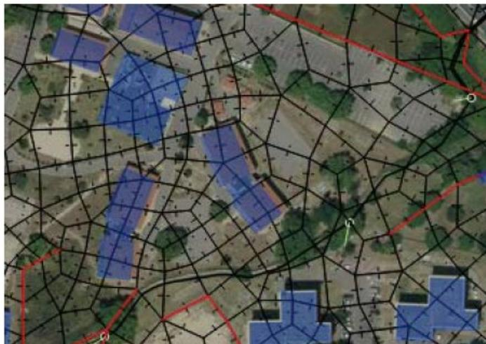
Figure 10 : Zoom sur le maillage du modèle (Source : Etude de connaissance de l'aléa inondation sur le bassin versant des Aygaldes – Phase 3 – Setec Hydratec)
