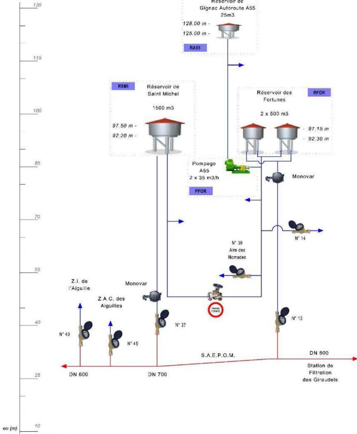
**Profil hydraulique du réseau d'alimentation en eau potable sur Gignac-la-Nerthe**
