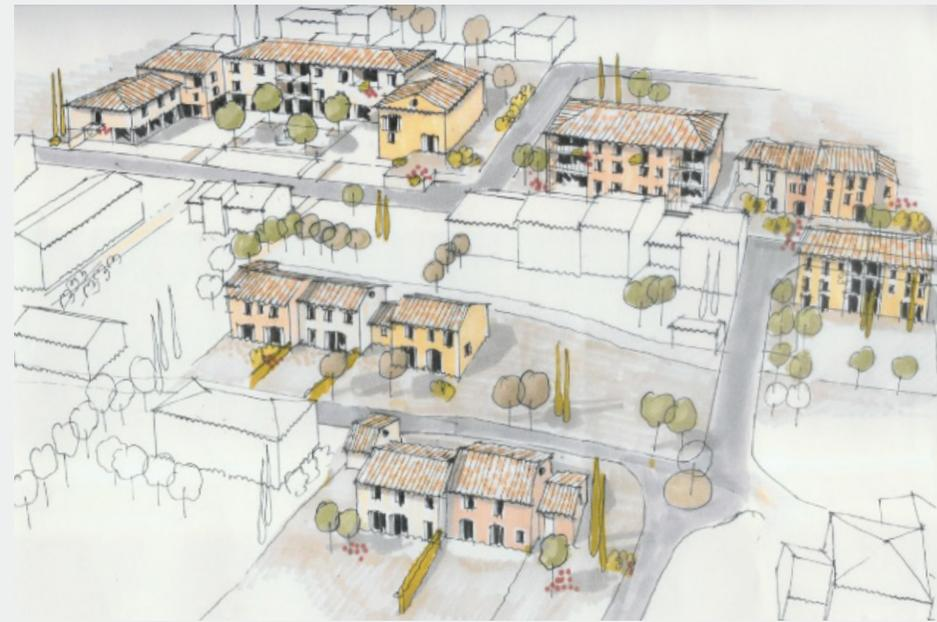
^ Ce croquis de l'architecte Manuel Canas montre l'implantation du projet dans le bâti ancien, la constitution d'une nouvelle place en bordure de l'avenue de la République, l'implantation d'immeubles à l'alignement des voies et la densification des terrains libres par la construction de maisons de village à R+1.
