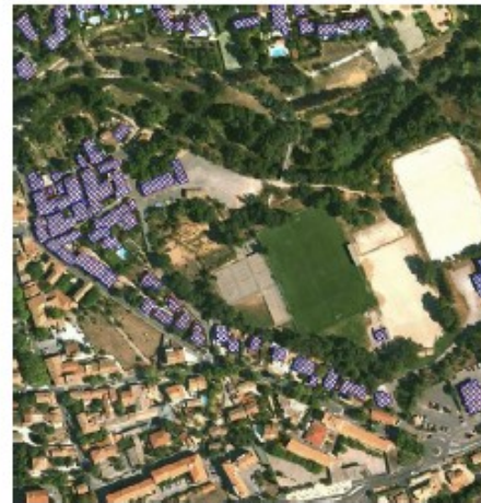
Prise en compte des bâtiments pour calculs hydrauliques de propagation. Définition des coefficients de rugosité.
