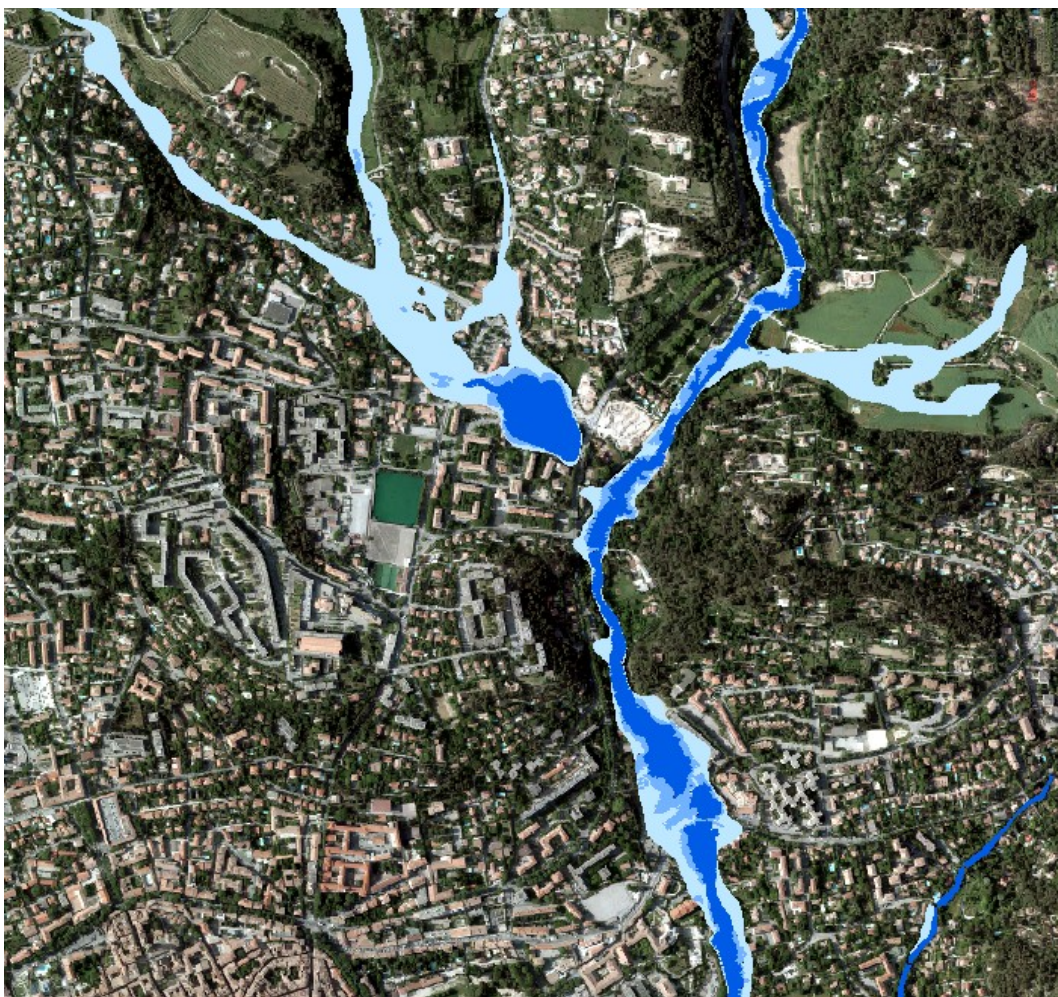
Figure 28 : Extrait du diagnostic hydraulique des réseaux pour la crue de référence – modèle de surface (source : SAFEGE – Aix-en-Provence, SDEP, 2011)
