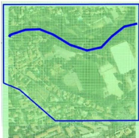
Définition du maillage de calcul (taille des mailles minimales 5 m), de l'aire d'étude en 2D et caractérisation du lit mineur (1D)
