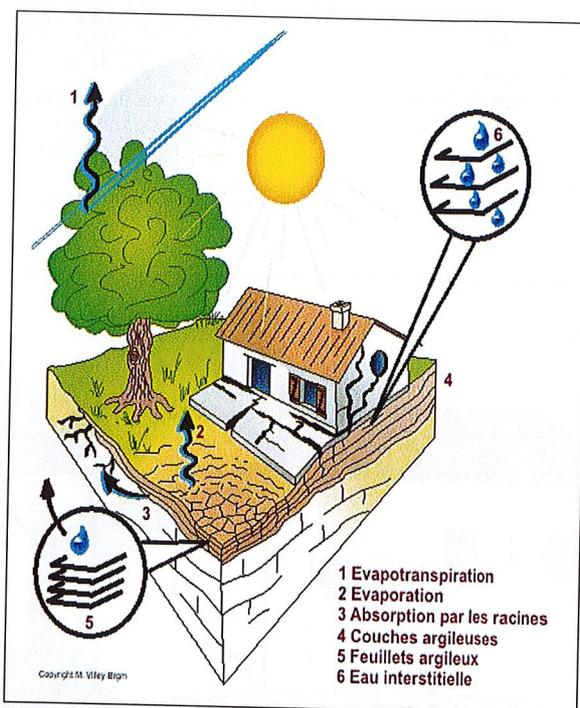
fig. 1 : illustration du mécanisme de dessiccation
