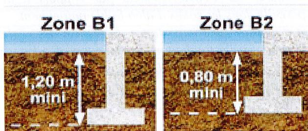
\* sur terrain en pente et pour les constructions réalisées sur plate-forme en déblais ou déblais-remblais, ces fondations doivent être descendues à une profondeur plus importante à l'aval qu'à l'amont afin d'assurer une homogénéité d'ancrage,
