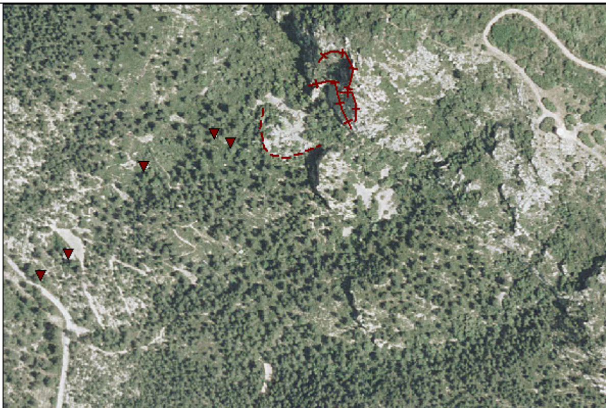
Traits avec barbules : cicatrices d'éboulement supposées ; trait discontinu : enveloppe de la masse éboulée ; Triangles : très gros blocs éboulés. (crédit http://www.geoportail.fr )
