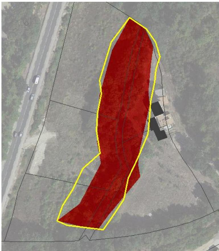
Figure 23 : Nouvelle zone inondable (en jaune) après les relevés géomètre
