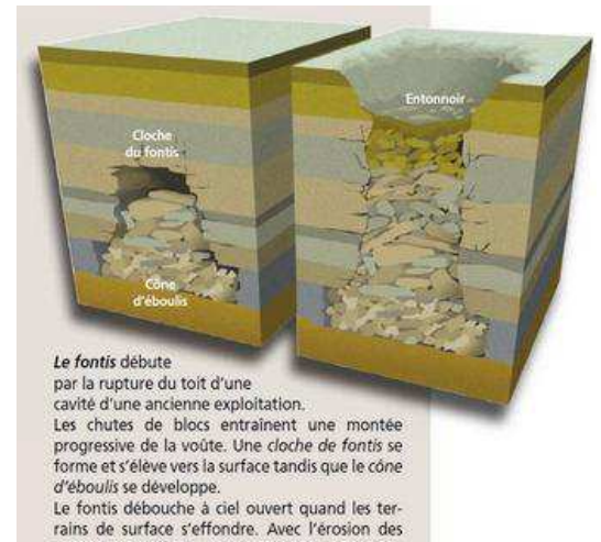
Illustration du phénomène d'effondrement localisé
