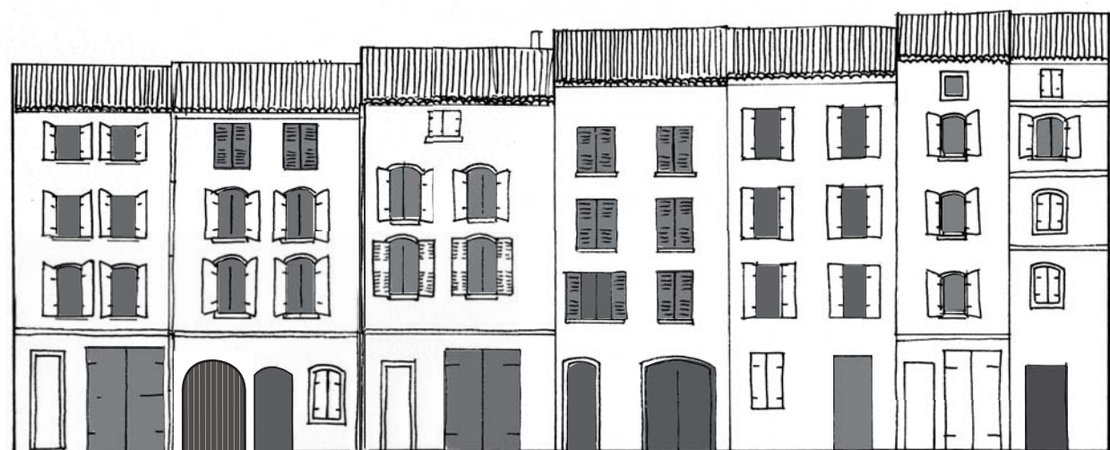
Rang d'immeubles type : 1 à 2 travées*, R+3 à R+3+étage d'attique. Rue de la Paroisse, Auriol.
